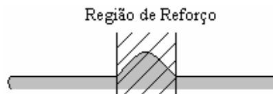
Figura 8. Região de reforço do perfil do cordão de solda.
